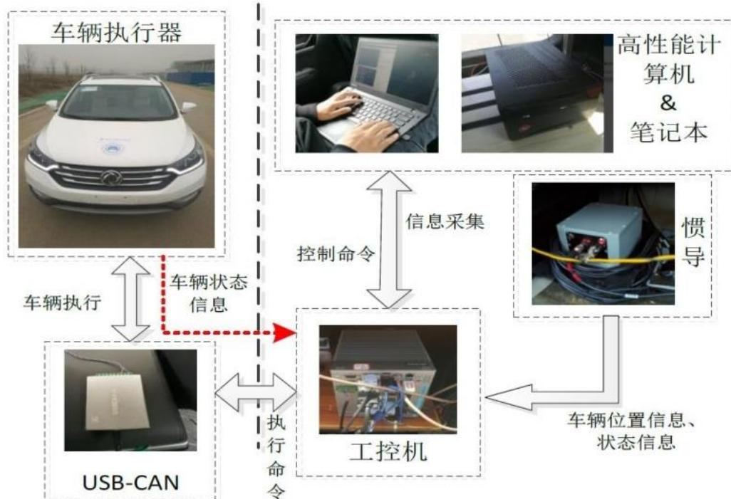
图 5.4 硬件结构框图
