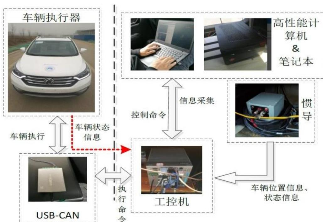
图 5.4 硬件结构框图
