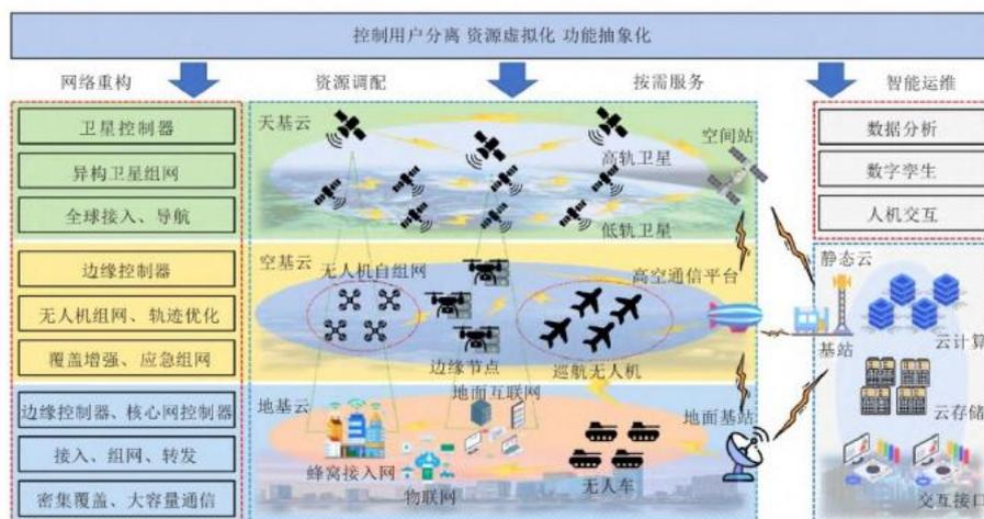
图 5.11 天空地结合智能协同控制系统框图
